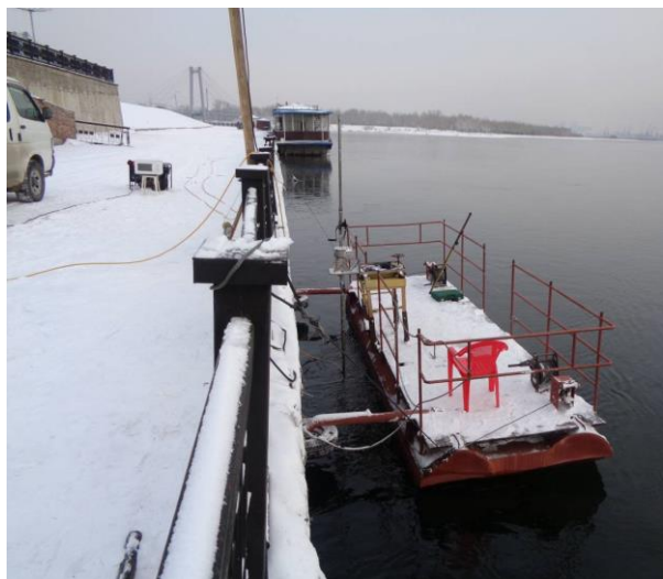
Понтон с гидролокатором для обследования причалов
