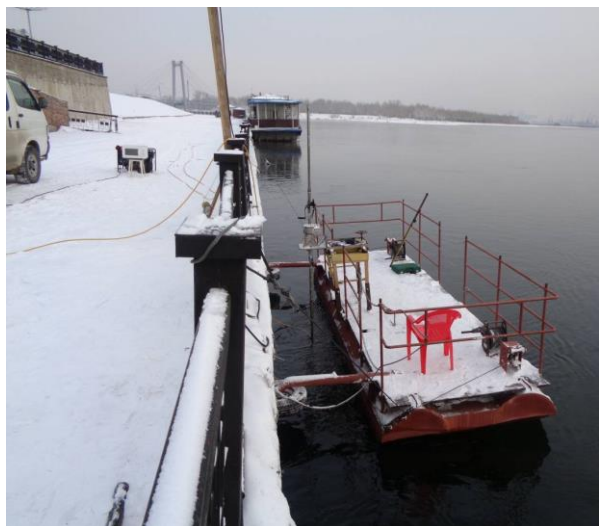
Понтон с гидролокатором для обследования причалов
